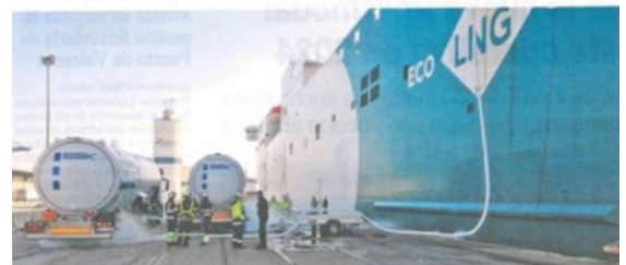
Operativo de suministro de Gas Natural Licuado para la naviera Baleárica, principal cliente de Grupo ESK. Foto: Baleárica
